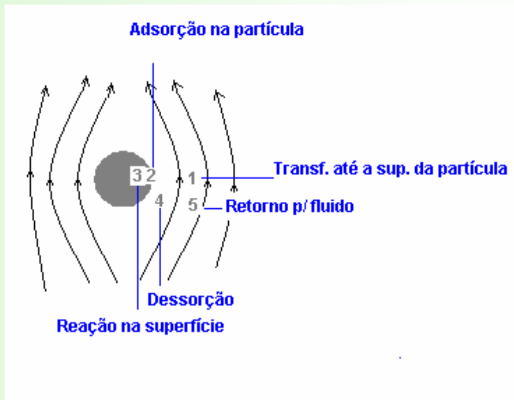
Figura 1: Esquema das etapas envolvidas na filtração adsortiva + oxidação.
